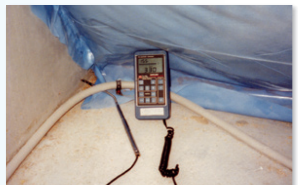
Leckageortung mit dem Anemometer
